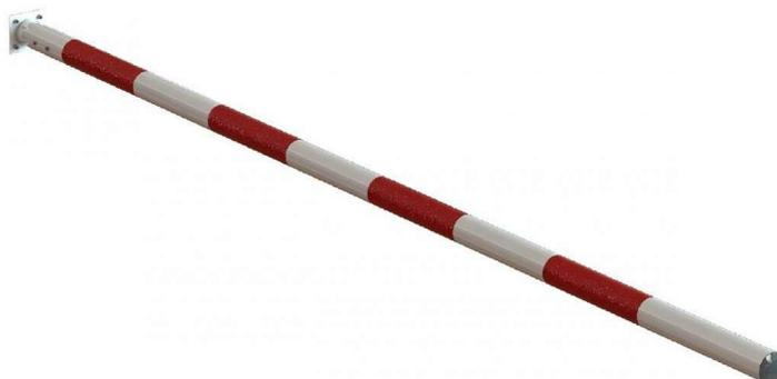
Стрелы К4(100)-К8(100) круглого сечения с функцией "антиветер" выполнены из прочной алюминиевой трубы сплав АД31Т диаметром 100мм и обладают высокой стойкостью к ветровым нагрузкам. На поверхность стрелы нанесены специальные светоотражающие полосы в виде наклеек, которые хорошо видны в темноте при попадании на них источника света, например, от фар.
